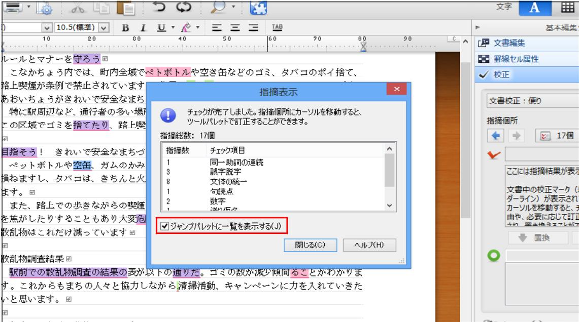
2. 画面の左側にジャンプパレットが表示され、指摘項目が一覧されました。ジャンプしたい項目をクリックします。
